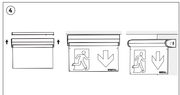
Snäpp fast armaturen på monteringsfästet. Slå på strömmen. Den gröns LED-indikatorn tänds.
